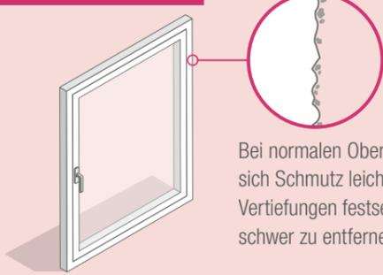
Bei normalen Oberflächen kann sich Schmutz leichter in den Vertiefungen festsetzen und ist schwerer zu entfernen.
