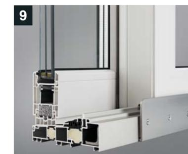
Der verschraubte Stahlwinkel an der Bodenschwelle bietet am Mittelstoß Schutz vor Einbruch mittels Kuhfuß.
